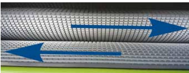
SHREDLAGE-Cracker: Die gegenläufigen, spiralförmigen Nuten sollen in Kombination mit einer hohen Drehzahldifferenz das Pflanzenmaterial stark auffasern und Körner zu Bruchstücken zerkleinern.
