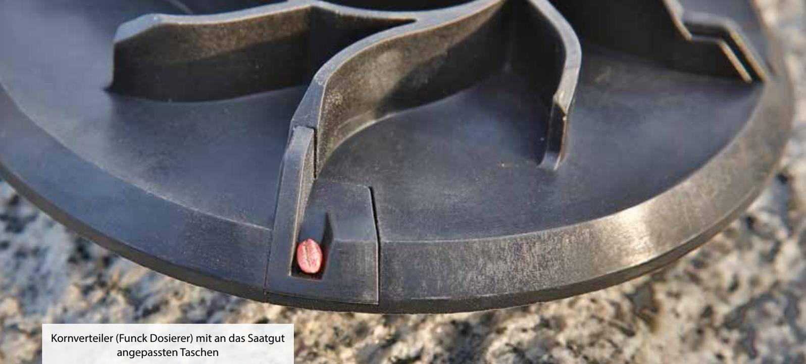
Kornverteiler (Funck Dosierer) mit an das Saatgut angepassten Taschen
