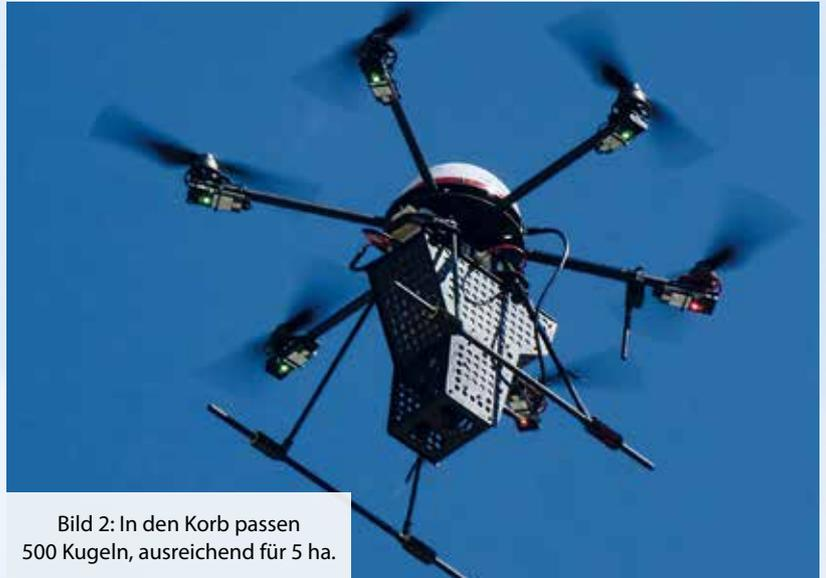
Bild 2: In den Korb passen 500 Kugeln, ausreichend für 5 ha.
