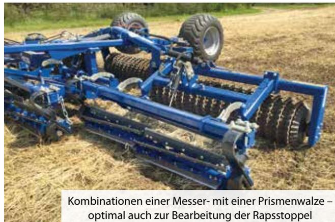
Kombinationen einer Messer- mit einer Prismenwalze – optimal auch zur Bearbeitung der Rapsstoppel
